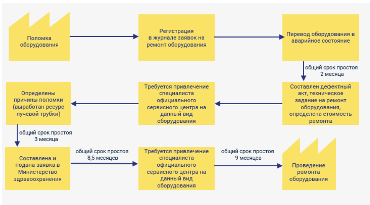
Рис.4 – Карта текущего состояния процесса технического обслуживания медицинского оборудования
